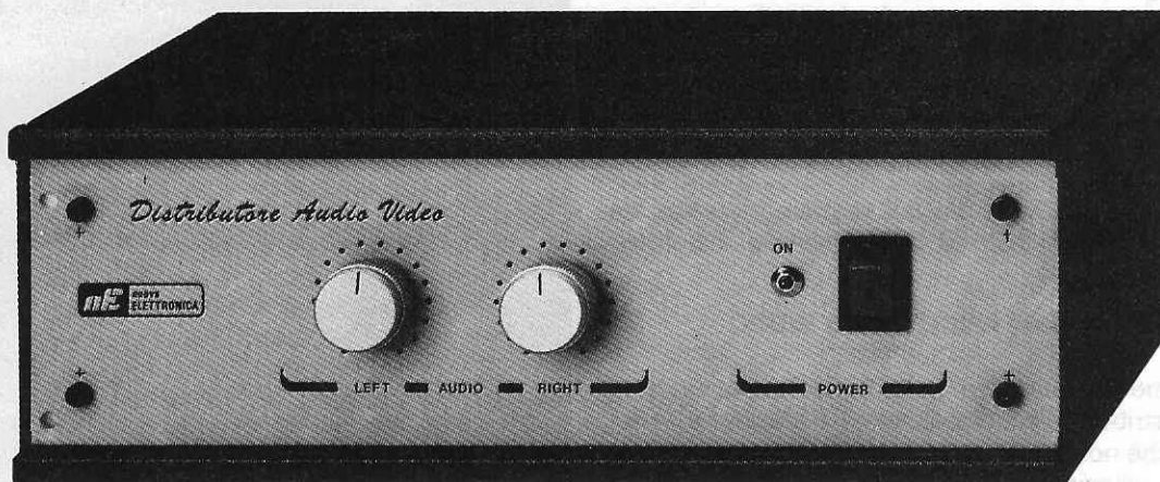
Fig.1 All'interno di questo mobile troveranno posto i due stadi Audio e Video, come visibile in fig.10. Come abbiamo spiegato nell'articolo, questo circuito vi permetterà di prelevare il segnale dalla presa videocomposita o Scart di un Videoregistratore o di una TV, per poi trasferirlo verso tre o quattro monitor, o videoregistratori, per fare delle duplicazioni di cassetta.
