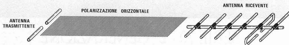
Fig.380 Se una emittente trasmette un segnale a polarizzazione ORIZZONTALE, per captarlo, l'antenna ricevente dovrà essere installata in senso orizzontale rispetto al suolo.
